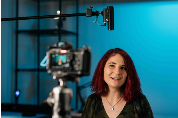
Profile Wireless peut également être utilisé pour créer une perche sans fil, ici en combinaison avec un mini-micro canon MKE 400.
